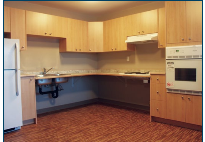
Figure 5 : Comptoirs de cuisine réglables en hauteur Photo : Ron Wickman
